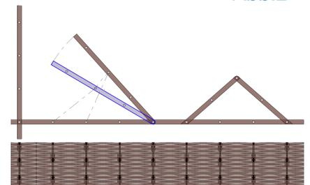
Unsere Montageprinzip ermöglicht es mehrere Lamellen vor ihrer Befestigung am Boden mithilfe von mechanischen Verbindungsstücken zusammenzufassen. (Abb. 3)
