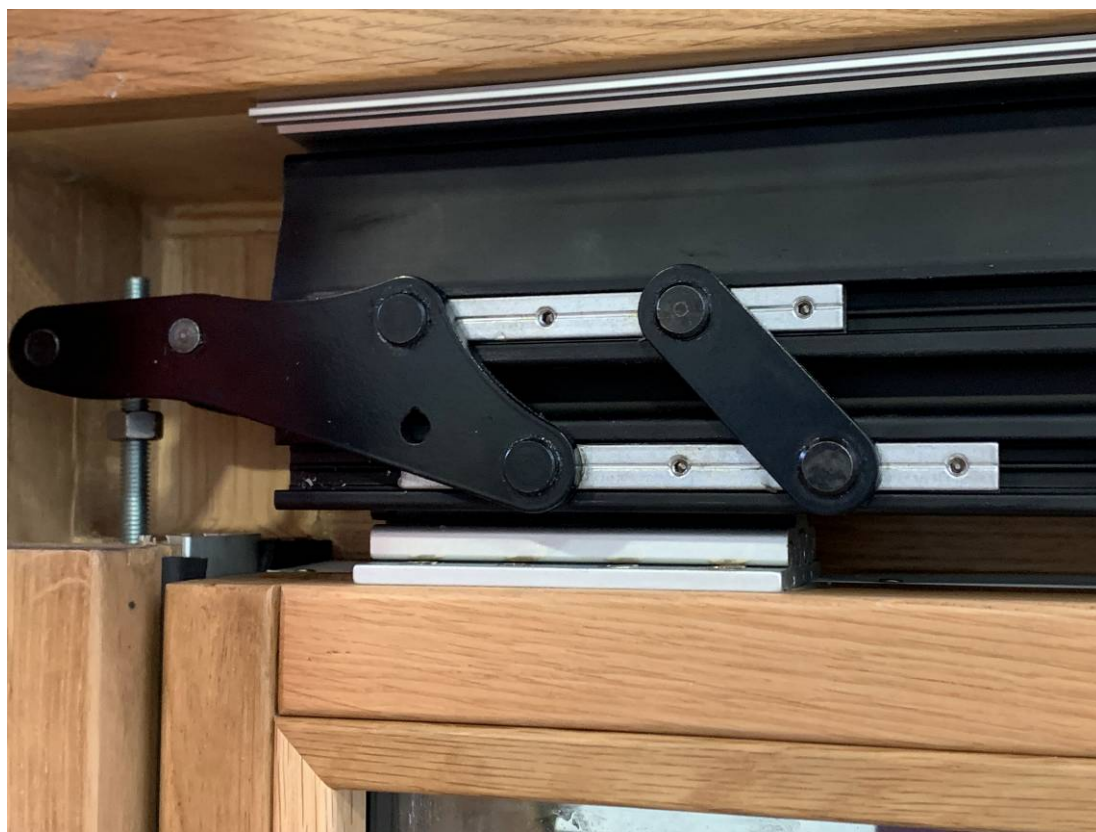
Foto 3: Détail point de fermeture haut de la maquette soumise à l'essai
