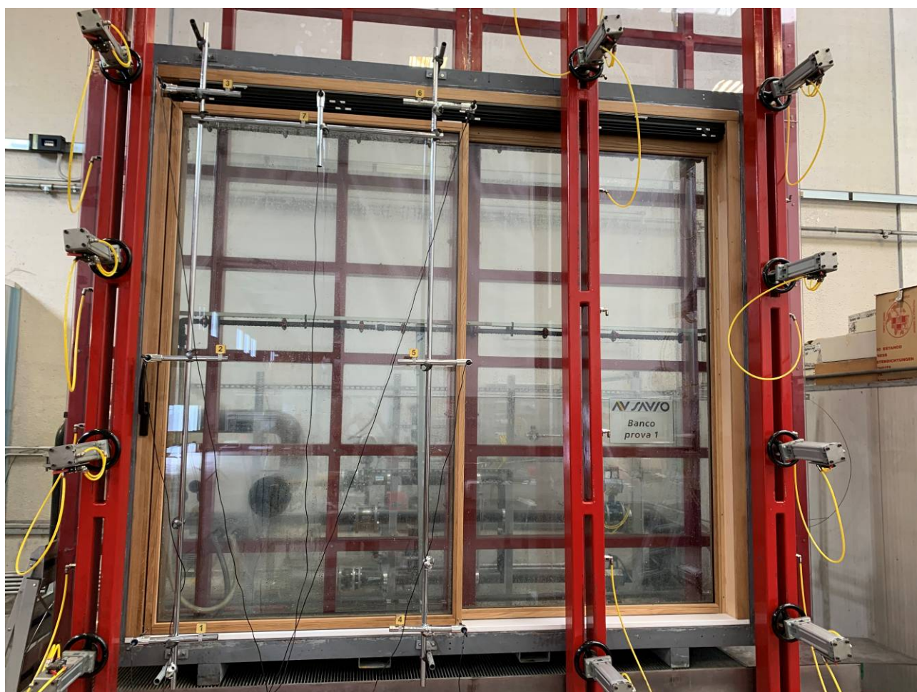
Photo 2: Échantillon parvenu et soumis à l'essai pendant les tests de résistance à la charge du vent
