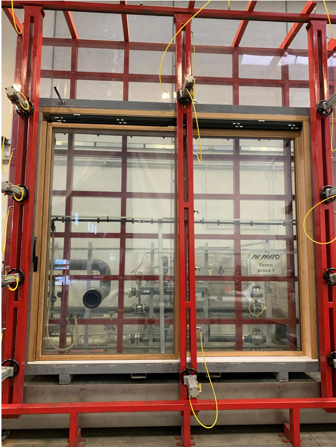
Photo 1: Échantillon parvenu et soumis à l'essai dans son agencement expérimental
